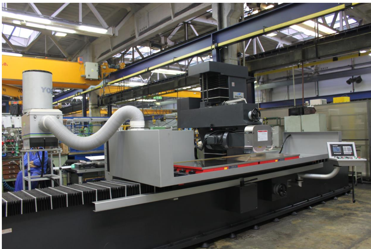
Rovinná bruska PSGO 75220AHR, zákazník: Formy Tachov, instalace leden 2015
