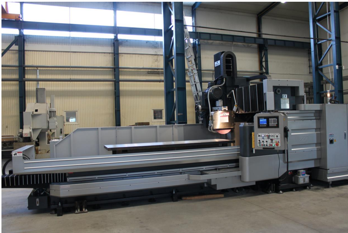
Rovinná bruska PSGP 1030AHR, zákazník: Bohler-Udenholm, instalace květen 2015
