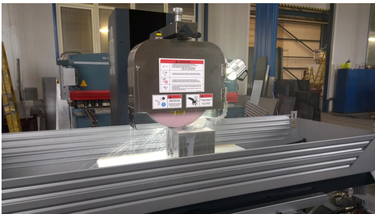
Rovinná bruska PSGS 4080 AHR, zákazník: Presshydraulika, instalace leden 2015
