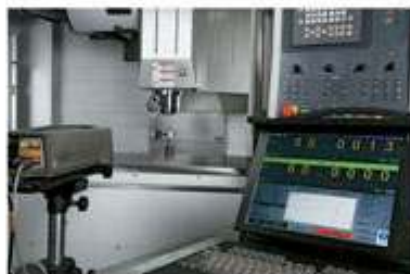
"H.P." laserový kalibrační systém zaručující přesnost lineární interpolace
