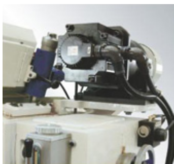
JHC-12S pohon regulačního kotouče servomotorem s plynulou regulací otáček
