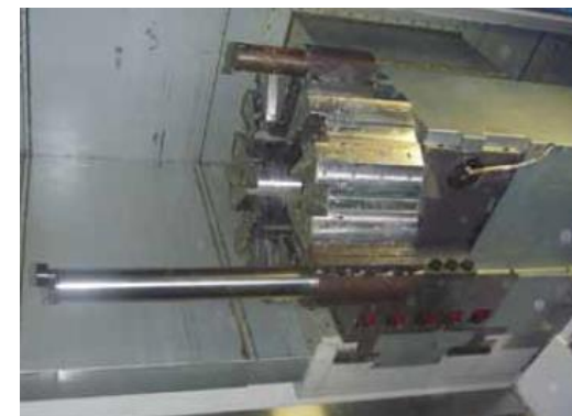
Vyvrtávání do hloubky 1000 mm
