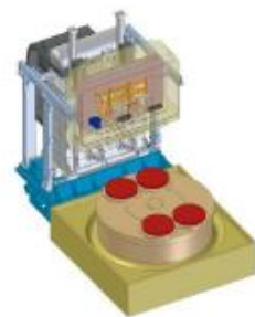
Rotační stůl B osa s výměnou palet
