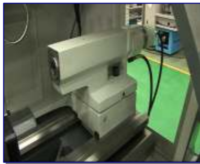
Hydraulický koník na CKE 6156Z
