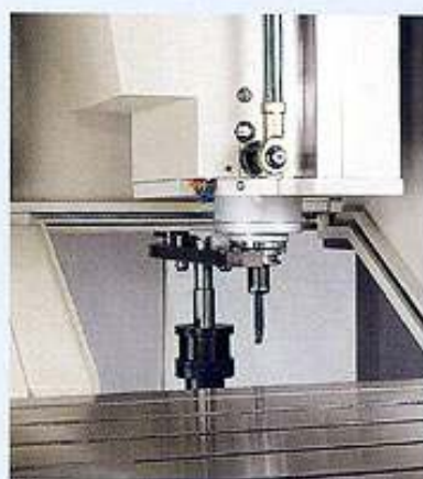
Rychlá automatická výměna nástroje (3 sec)
