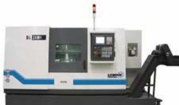
Produkcční CNC soustruhy se šikmým ložem s točným průměrem nad ložem 400 - 800 mm
