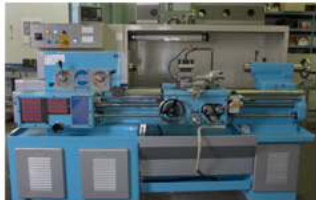
SV 18 po provedené generální opravě s plynulou regulací a digitálním odměřováním
