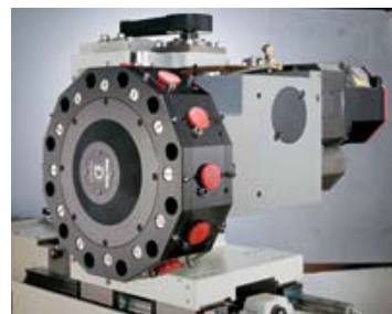
Provedení s Y osou
